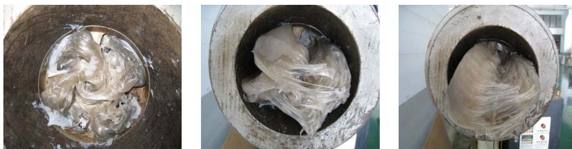
圖 28 行星式螺桿 HDPE 試車實況
